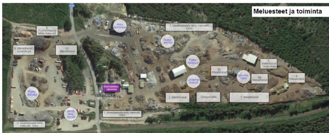
Kuva 10. Kartta laitosalueesta, johon on sijoitettuna laitoksen toiminnot ja melusteiden sijainnit. (Kuva: Vastine meluvalitukseen, Eurajoen Romu Oy, 30.8.2021)
